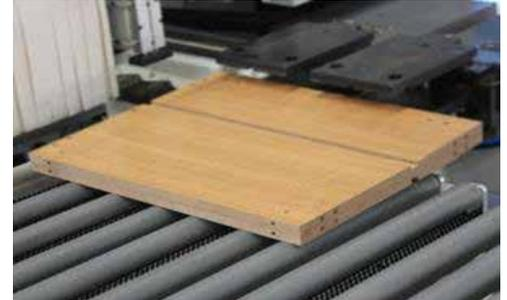
El sistema detecta las medidas de las dimensiones del panel en tiempo real
